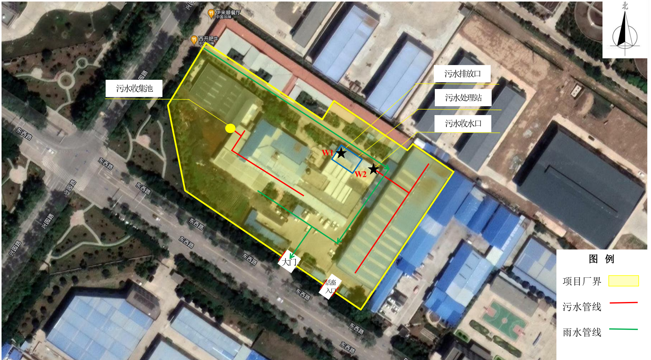
附图3 项目污水管网图
